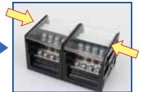
端子台間に隙間がなくなるよう左右から押し込む
