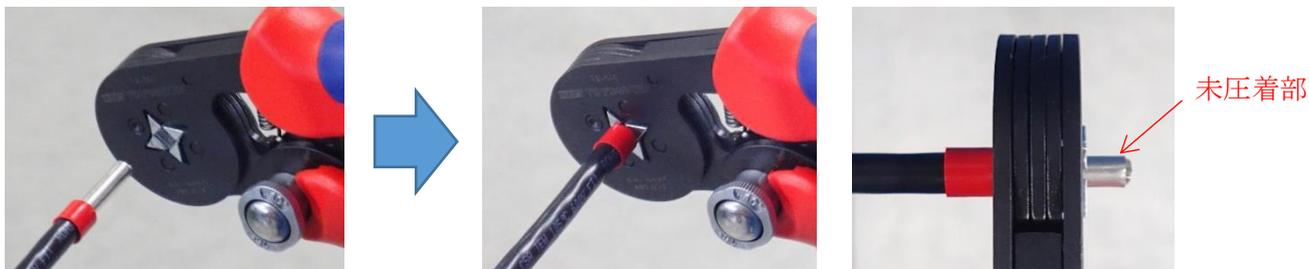
②上記の状態から フェールをひねらないようにずらし、未圧着部を圧着します。
