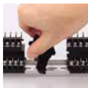
①片方の足を傾けてレールに引っ掛ける。
