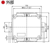
(固定金具使用時 取付ビッチ) 133 (固定金具使用時) 143.2
