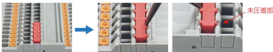
①導電部の末端(被覆側)までフェールを差し込み、圧着します。
