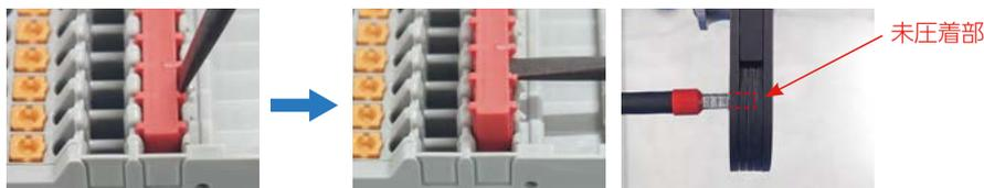
②上記の状態からフェールをひねらないようにずらし、未圧着部を圧着します。
