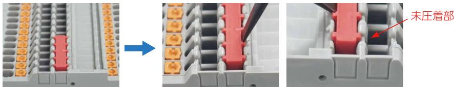
①導電部の末端(被覆側)までフェルールを差し込み、圧着します。
