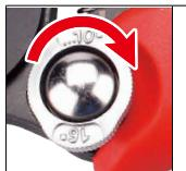
0.14㎟ (AWG 26) ~ 10㎟ (AWG 6)までの電線を圧着する際にはノブを“…10□”の位置、16㎟ (AWG5)を圧着する際には“16□”の位置に切替えてご使用ください。
