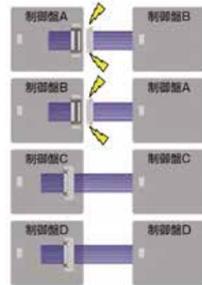
※ATX-10/ATX-30、レバー固定式/ネジ固定式ともに誤挿入防止の施工が可能です。
