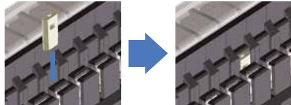
②対になる上部端子台の突起をニッパーで切断する
