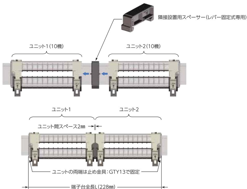
$$\text{端子台全長}L = (\text{端子台幅}(\square\text{mm}) \times \text{総極数}) + (32\text{mm} \times \text{総ユニット数}) + 4\text{mm}$$
