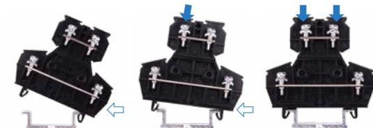
⇐ 箇所に片方の足を傾 ⇐ 方向に押し付けなが ↓ 方向に完全に押さえ込んでレールに引っ掛ける。ら ↓ 方向に押さえ込む。込みセット完了。
